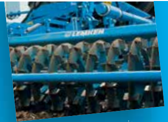
Кільчато-шпоровий коток із зміщеними кільцями для оптимального зворотного ущільнення та подрібнення
