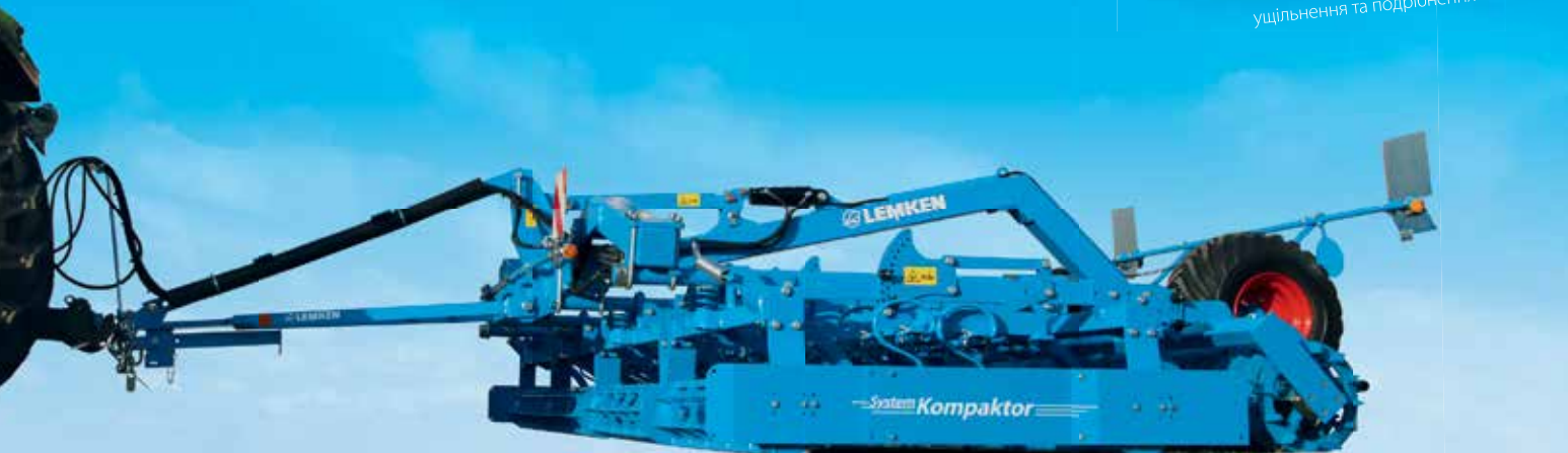
Кільчато-шпоровий коток із зміщеними кільцями для оптимального зворотного ущільнення та подрібнення
